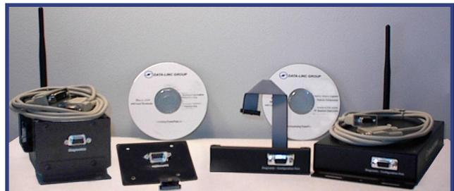
*LincView OPC* requiere de la opción de puerto de diagnóstico DB9 en el radio maestro. El kit instalable incluye un puerto DB9 para cada interfase serial o de Ethernet con todo el hardware necesario y el software *LincView OPC*.
